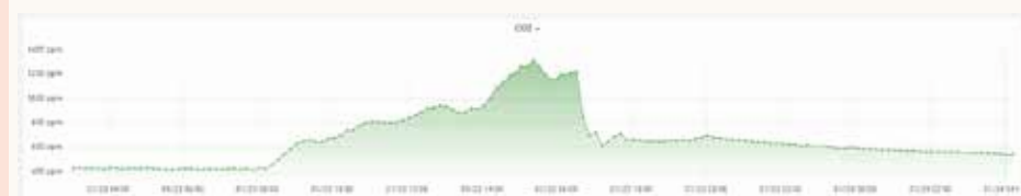
Slika 2: Spreminjanje koncentracije CO 2 v pisarniškem prostoru.
